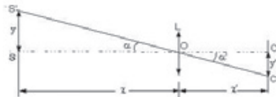
Fig. 05 – Raffigurazione del diagramma utilizzato nella spiegazione del percorso delle radiazioni e del rapporto tra y e y' legato a quello di x e x' . L =sistema ottico positivo. y alla distanza SS' ; y' =alla distanza CC' .
